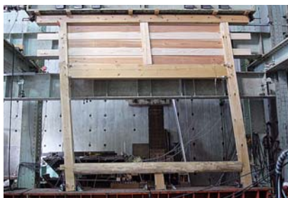
図5 試験体A(最大変形時)
